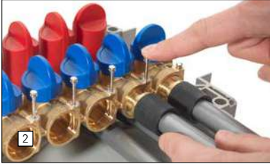
Şek. 7 Emniyet pimini işitilebilir klik sesi ile kilitlenene kadar aşağı bastırın
