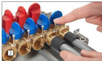
Fig. 7 Apăsarea șplintului de siguranță în jos până când se fixează cu zgomot
