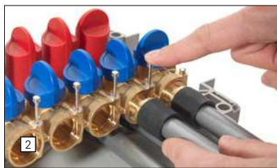
фиг. 7 Натиснете предпазния шплинт надолу, докато се чуе щракване
